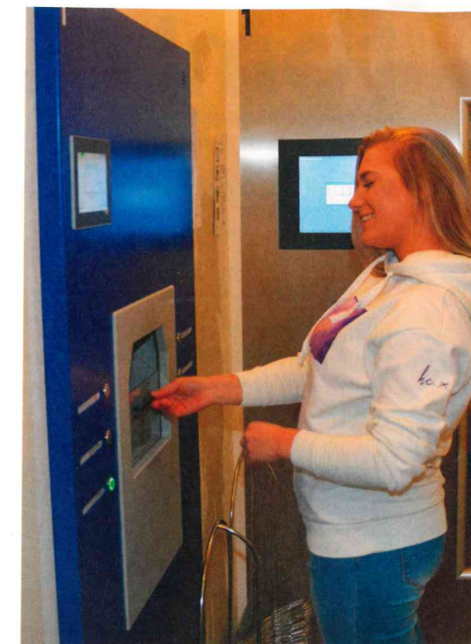
Wäscheausgabe: Anhand der Personalnummer erkennt der Automat, welches Modell er in welcher Größe ausliefern muss.
